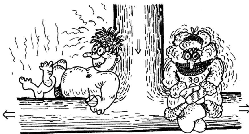
Рис. 15. Вихревая труба Д.Ранка в воображении художника. Газ, входящий сверху по трубе, расслаивается на левый — горячий — поток и правый — холодный поток. Внутри трубы имеется не показанное художником сопло, перпендикулярное оси трубы, через которое со звуковой или сверхзвуковой скоростью входит газ
