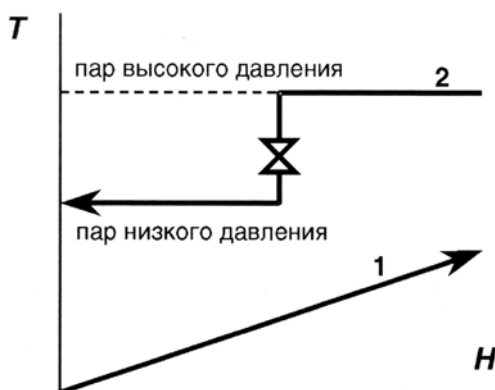
Рис. 47. Вредные потери движущей силы теплопередачи между жидкостью 1 и водяным паром 2 в результате дросселирования пара [43]
